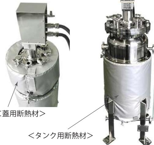
火傷防止のため、タンクと蓋にそれぞれ断熱材を装着。高温対応仕様の攪拌機を搭載。
