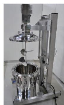
自動（エア駆動）で攪拌機付蓋を昇降する機構。
